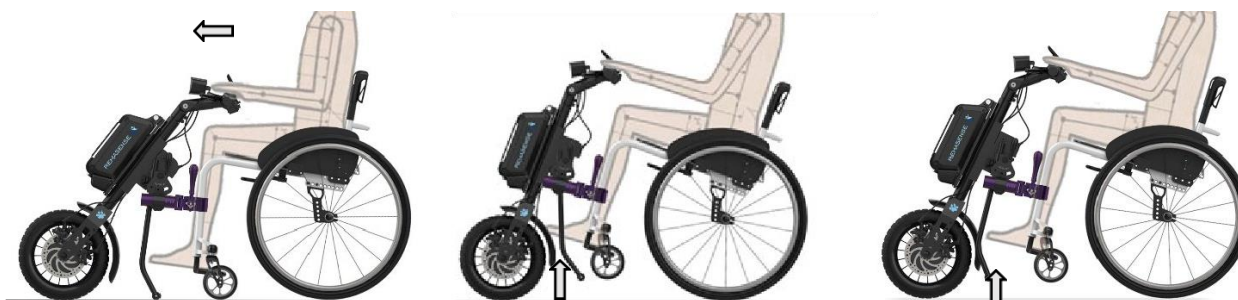
37 pav. Rankinių spaustuvų ir (arba) kėlimo įtaisų stovėjimo (1), miesto (3) ir kelionių (2) padėtys
