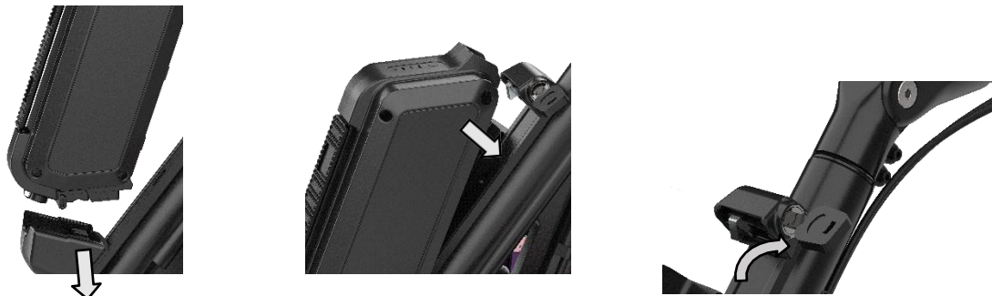
42 pav. Akumuliatoriaus įdėjimas į akumuliatoriaus laikiklį.
