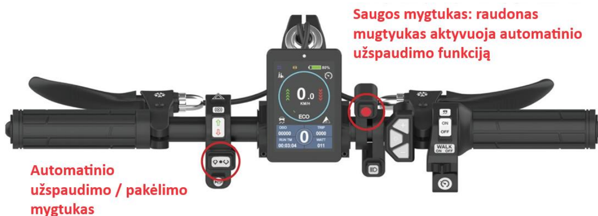
10 pav. Automatinis užspaudimo ir pakėlimo jungiklis
