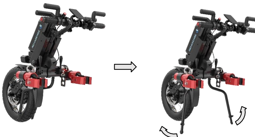
28 pav. Atraminių kojų pasukimas į stovėjimo padėtį
