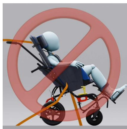
Pav. 20d Neteisingas prisegimas Klubų ir krūtinės saugos diržas – vaizdas iš šono
